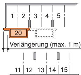
Bei Verwendung des **Antriebs D** ist keine einseitige ParkBoard-Verlängerungen notwendig. Der **Antrieb D** erlaubt einen längeren Verfahrweg.
