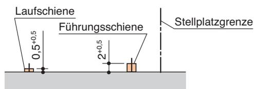
**!** Der Überstand der Führungsschiene über OKFFB ist zwingend auf beiden Seiten der Schiene inklusive Ebene für den Antrieb notwendig!
