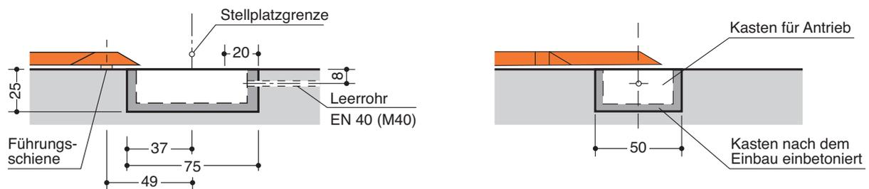
Das Leerrohr EN 40 mit Zugdraht zur nächsten Stütze oder zur Wand verlegen.
